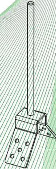
Bild 9: Anschlagereinrichtung, Typ: ZS 300-800 FIRST, mit gekanteter Grundplatte
